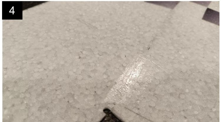
Der Kleber muss nicht über die ganze Länge aufgetragen werden. Ca. 3 cm an beiden Enden reichen, um das EPP-Scharnier zu verstärken.
