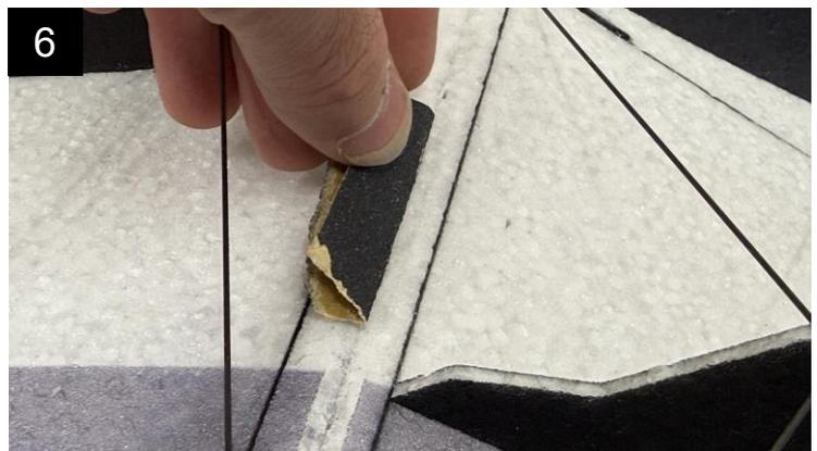
Durch Fertigungstoleranzen kann es sein, dass das Material im Scharnier zu dick und dadurch schwergängig ist. Dann vorsichtig mit etwas gefaltetem Schleifpapier (ca. 200er Körnung) die Scharnierlinie dünner schleifen.
