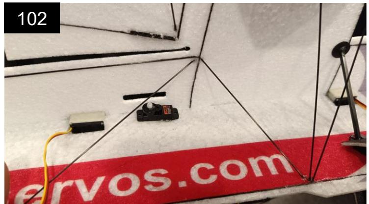
Beim Höhenruderservo musst du darauf achten, dass der Abtrieb mittig unter der Aussparung sitzt. Siehe Bild.
