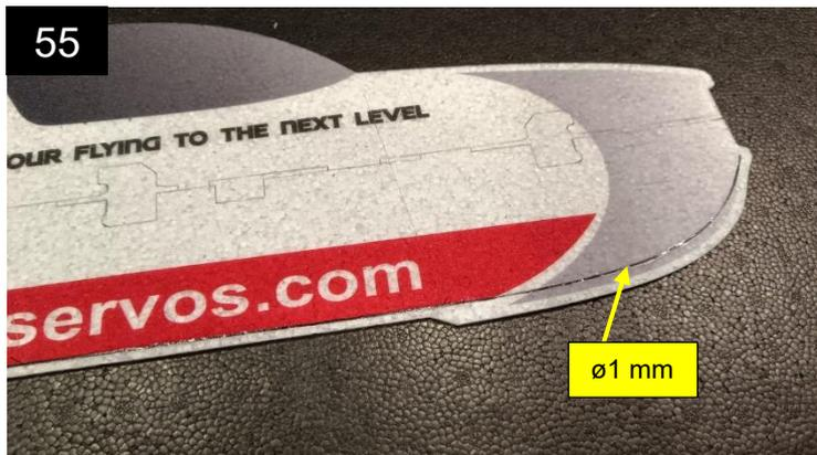
Unten am Rumpf kommt wieder ein  $\varnothing 1$ -mm-CfK-Stab als Verstärkung zum Einsatz.
