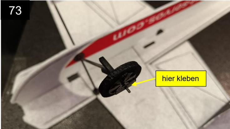
Setze nun die vorbereiteten Räder auf die Achsen. Achte darauf, dass sie sich leicht drehen lassen. Dann werden die Träger für die Radschuh aufgeschoben und von außen mit einem Tropfen Kleber gesichert.
