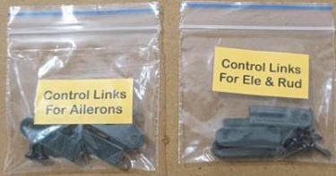
Querruder und Seiten-/Höhenruder werden mit unterschiedlich dicken CfK-Stäben angesteuert. Für die Querruder nehmen wir  $\varnothing 1,5$  und für Höhe sowie Seite  $\varnothing 1,2$  mm. Entsprechend unterscheiden sich auch die Gestängeanschlüsse.
