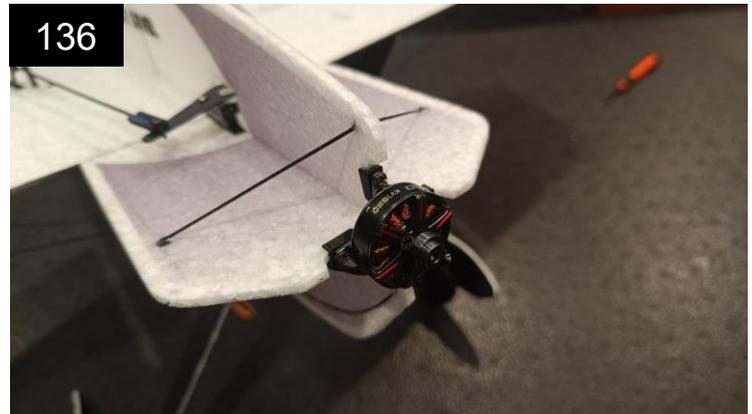
Schraube deinen Motor fest. Die Bohrungen im Motorträger können passend zu den Schrauben etwas aufgebohrt werden.
