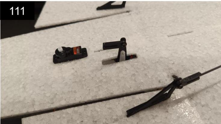
Achte darauf, dass das Höhenruderservo auf Neutral steht. Der Hebel sollte so wie im Bild nach oben durch das EPP zeigen.
