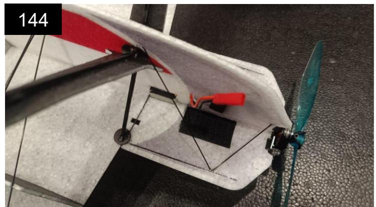
Das lange Klettbandstück dient der Akkubefestigung. Ehe du es aufklebst, prüfe wo der Akku für eine korrekte Schwerpunktlage liegen muss.
