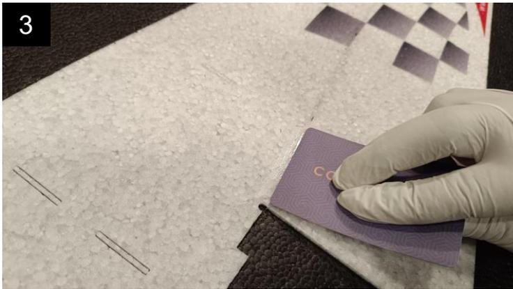
Es ist sehr wichtig, den Klebstoff zuerst auf die Karte aufzutragen. Erst dann trägst du eine dünne Schicht Kleber auf das Scharnier auf. Anders könnte das EPP vom Kleber angeschmolzen werden.
