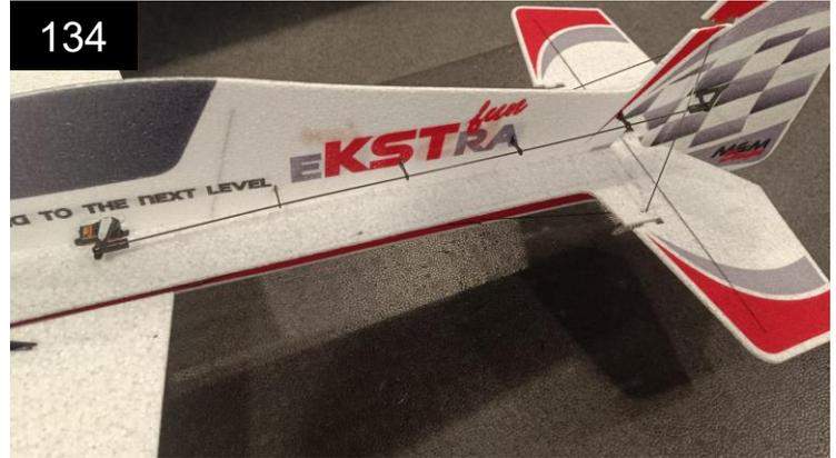
Die Seitenruder-Anlenkung wird wie die des Höhenruders eingebaut. **Anschließend prüfe bitte, dass das Höhenruder nicht mit der Seitenruder-Anlenkung kollidiert. Eventuell musst du dazu etwas Material am Höhenruder wegnehmen.**
