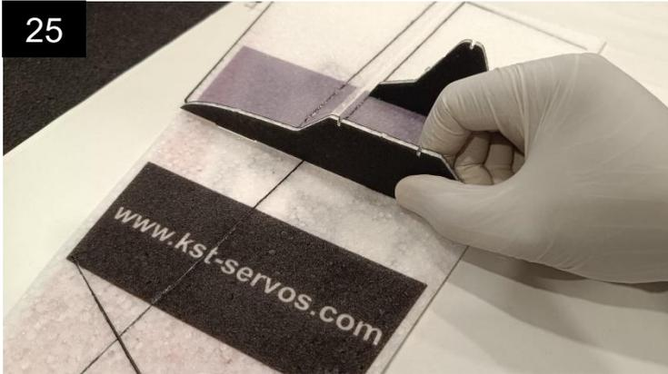
25 Dann werden die Unterteile der SFGs, die gleichzeitig auch als Dome für die Verstärkungen dienen, festgeklebt.
