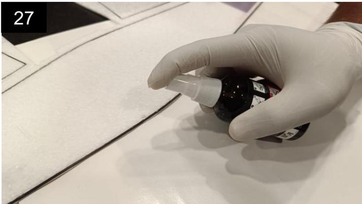
27 Auf das Gegenstück an der Tragfläche wird Aktivator aufgesprüht.
