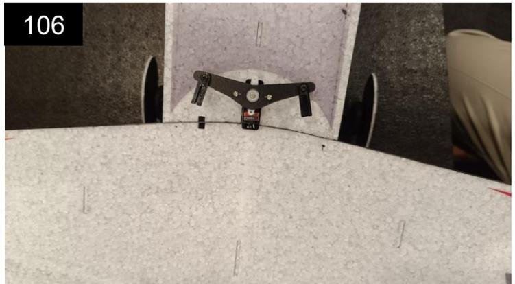
Setze den Hebel in Neutralstellung auf das Servo. Bei extremer Abweichung nochmal demontieren und den V-Hebel um  $180^\circ$  gedreht montieren.
