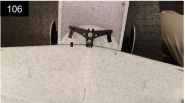
Setze den Hebel in Neutralstellung auf das Servo. Bei extremer Abweichung nochmal demontieren und den V-Hebel um 180° gedreht montieren.
