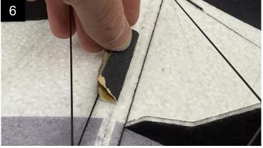
Durch Fertigungstoleranzen kann es sein, dass das Material im Scharnier zu dick und dadurch schwergängig ist. Dann vorsichtig mit etwas gefaltetem Schleifpapier (ca. 200er Körnung) die Scharnierlinie dünner schleifen.
