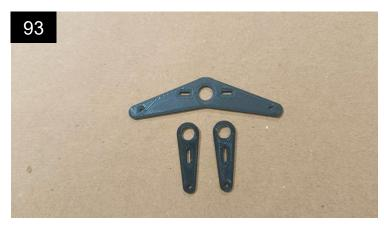
Nun legst du die Servohebel-Verlängerungen bereit. Der abgewinkelte ist für die Querruderanlenkung. Die beiden geraden können verwendet werden, wenn die Servohebel nicht ausreichen. Benötigte Hebellängen: Höhenruder: 20 mm, Seitenruder: 17 mm
