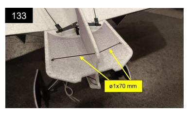
Die Rumpfverstärkungen vorn oben sind 70 mm lang und werden mit dünnflüssigem Sekundenkleber in die vorgesehenen Öffnungen eingeklebt.
