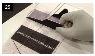
Dann werden die Unterteile der SFGs, die gleichzeitig auch als Dome für die Verstärkungen dienen, festgeklebt.
