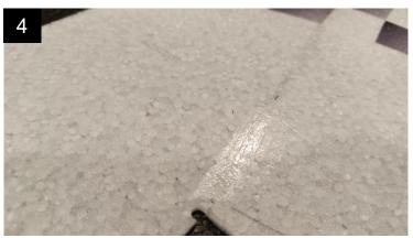
Der Kleber muss nicht über die ganze Länge aufgetragen werden. Ca. 3 cm an beiden Enden reichen, um das EPP-Scharnier zu verstärken.
