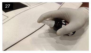
Auf das Gegenstück an der Tragfläche wird Aktivator aufgesprüht.
