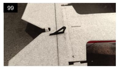
Der Höhenruder-Hebel wird wie im Bild mit dickflüssigem Sekundenkleber eingeklebt. Achte darauf, dass er komplett aufliegt.
