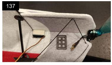
Dem Bausatz liegt eine Platte bei, die du benutzen kannst, um den Drehzahlsteller zu befestigen.
