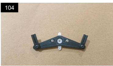
Schraube zwei 1,5-mm-Anschlüsse an den Querruder-Servohebel. Auf Leichtgängigkeit achten! Hierbei hilft es, die Schraube zunächst nur durch die Bohrung des Gestängeanschlusses zu schrauben und einige Umdrehungen "zu überdrehen".
