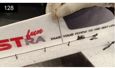
Schneide ein passendes Stück ø1-mm-CfK zurecht und setze es ein. Eventuell musst du die Vertiefung etwas reinigen.
