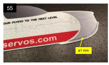
Unten am Rumpf kommt wieder ein ø1-mm-CfK-Stab als Verstärkung zum Einsatz.
