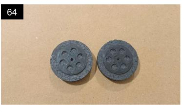
Als erstes werden die Felgen von beiden Seiten auf die EPP-Reifen geklebt. Benutze dazu bitte dickflüssigen Sekundenkleber.
