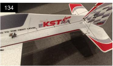
Die Seitenruder-Anlenkung wird wie die des Höhenruders eingebaut. Anschließend prüfe bitte, dass das Höhenruder nicht mit der Seitenruder-Anlenkung kollidiert. Eventuell musst du dazu etwas Material am Höhenruder wegnehmen.
