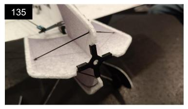
Der Motorträger wird von vorn mit dickflüssigem Sekundenkleber auf den Rumpf geklebt. Achte darauf, dass alles sauber aufliegt.
