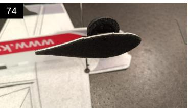
Als nächstes werden die Radschuhe mit dickflüssigem Sekundenkleber aufgeklebt.
