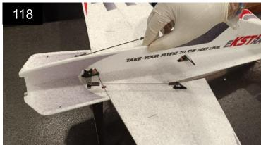
Jetzt setzt du die Oberseite des Rumpfs auf und prüfst die Passung. Passe die Aussparungen an, falls nötig.
