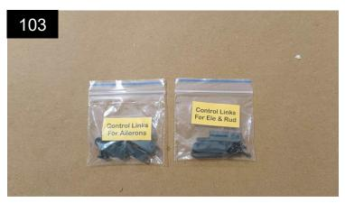
Querruder und Seiten-/Höhenruder werden mit unterschiedlich dicken CfK-Stäben angesteuert. Für die Querruder nehmen wir ø1,5 und für Höhe sowie Seite ø1,2 mm. Entsprechend unterscheiden sich auch die Gestängeanschlüsse.
