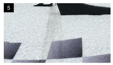
Alternativ kannst Du die Scharnierlinie auch mit transparentem Klebeband verstärken. Trage hierfür vorher UHU por als Haftvermittler auf und lass ihn antrocknen.
