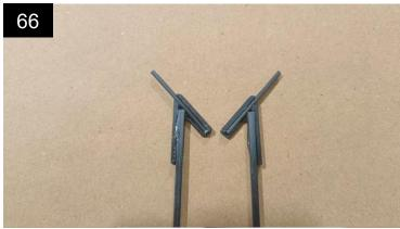
Bei Bedarf sorgt Schrumpfschlauch über den Klebstellen für eine schickere Optik.
